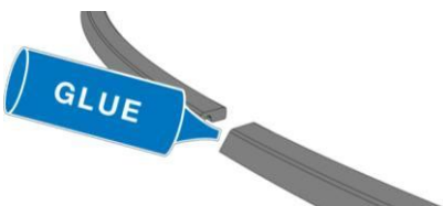
Рис. 34: Покрытие разделяющихся точек клеем
