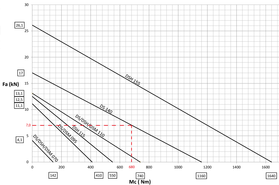
Fig. 9.2: Allowable load for the tilting moment and the axial force Zulässige Belastung für Kippmoment und die Axialkraft.
