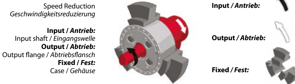
Fig. 9.1: Schematic diagram of inputs, outputs and rotation direction Schema-Diagramm von Antrieben, Abtrieben und Rotationsrichtung
