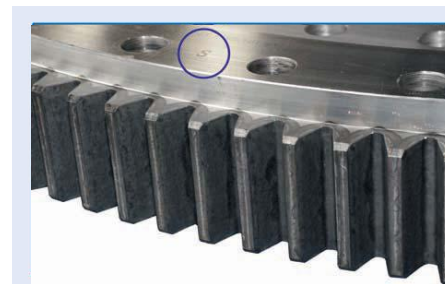
Kenzeichnung des Härteschlupfes Markierung einer weichen Stelle
