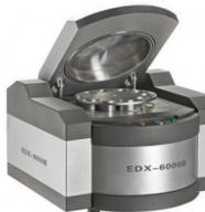
**Энерго-дисперсионный рентгенофлуоресцентный спектрометр EDX 6000B**
