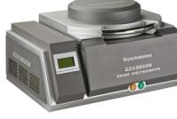
**Энерго-дисперсионный рентгенофлуоресцентный спектрометр EDX 3600N**
